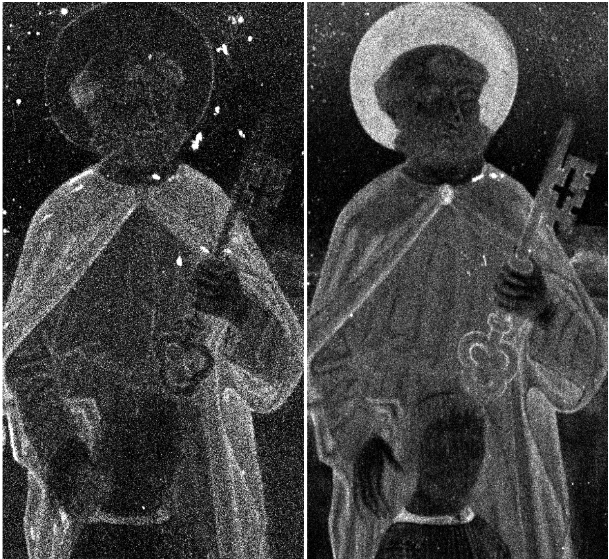
Figuur 2: MA-XRF verdeling van calcium (links) en ijzer (rechts)
