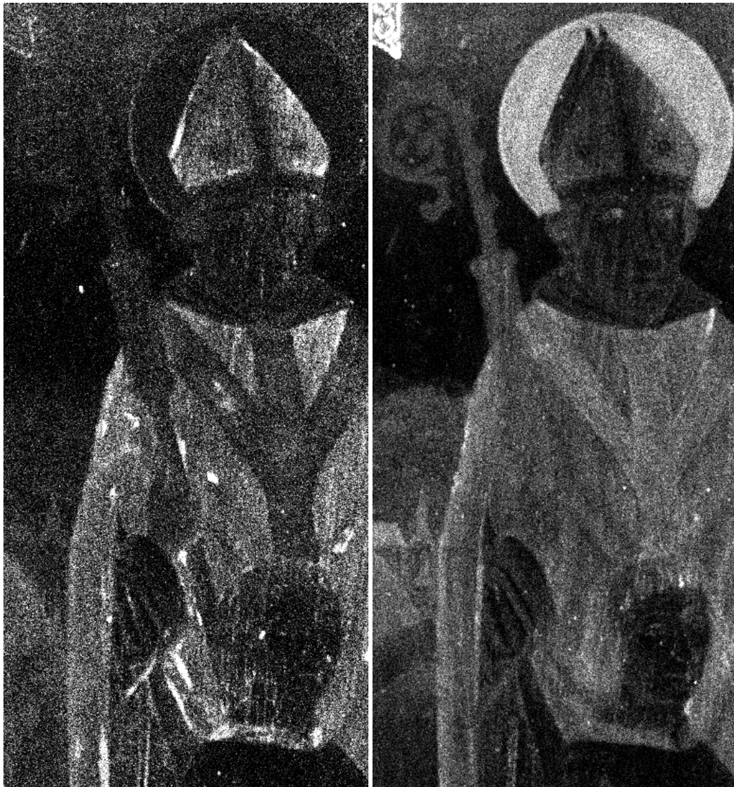
Figuur 10: MA-XRF verdeling van calcium (links) en ijzer (rechts)
