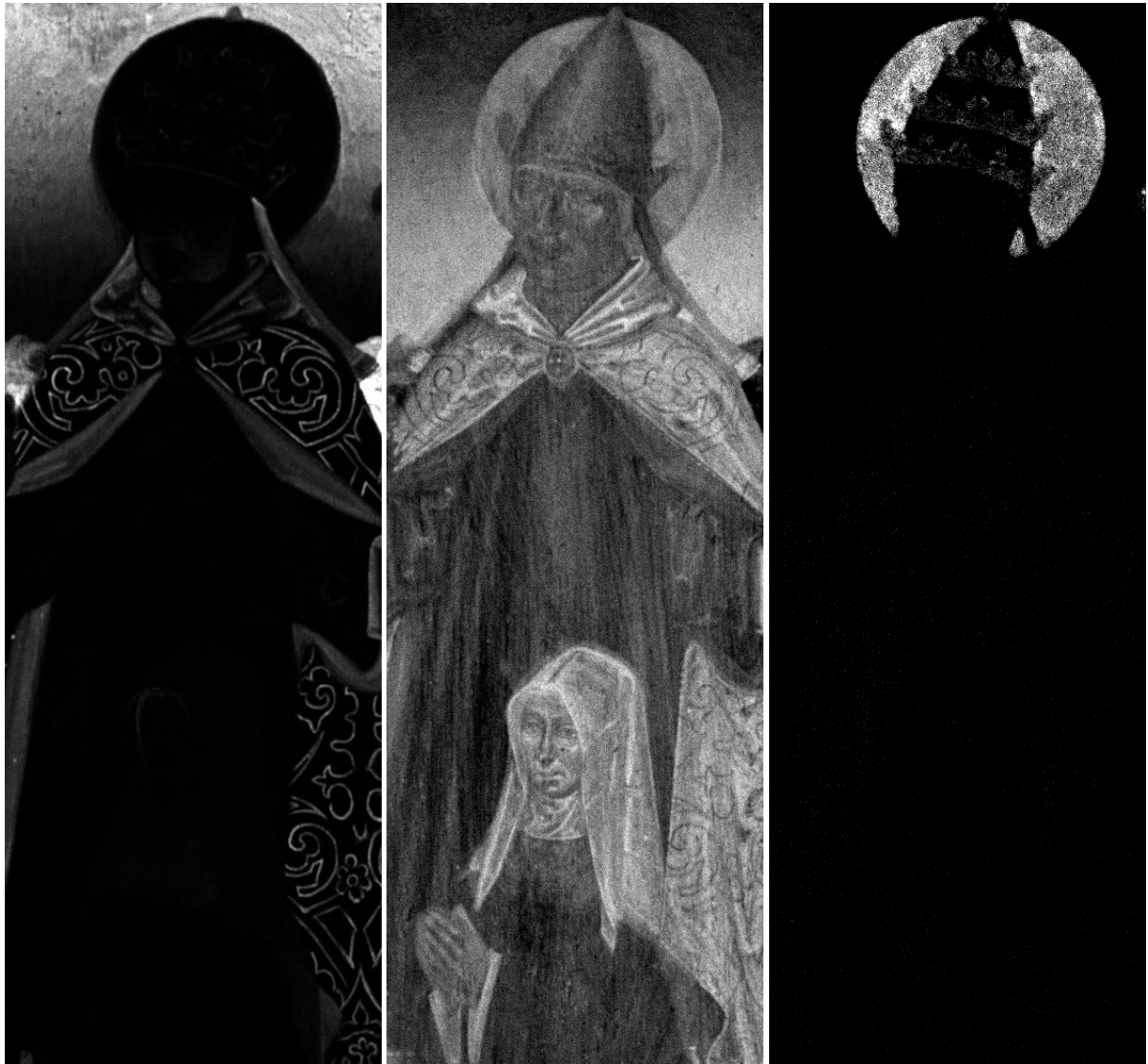
Figuur 7: MA-XRF verdeling van koper (links), lood (midden) en goud (rechts)
