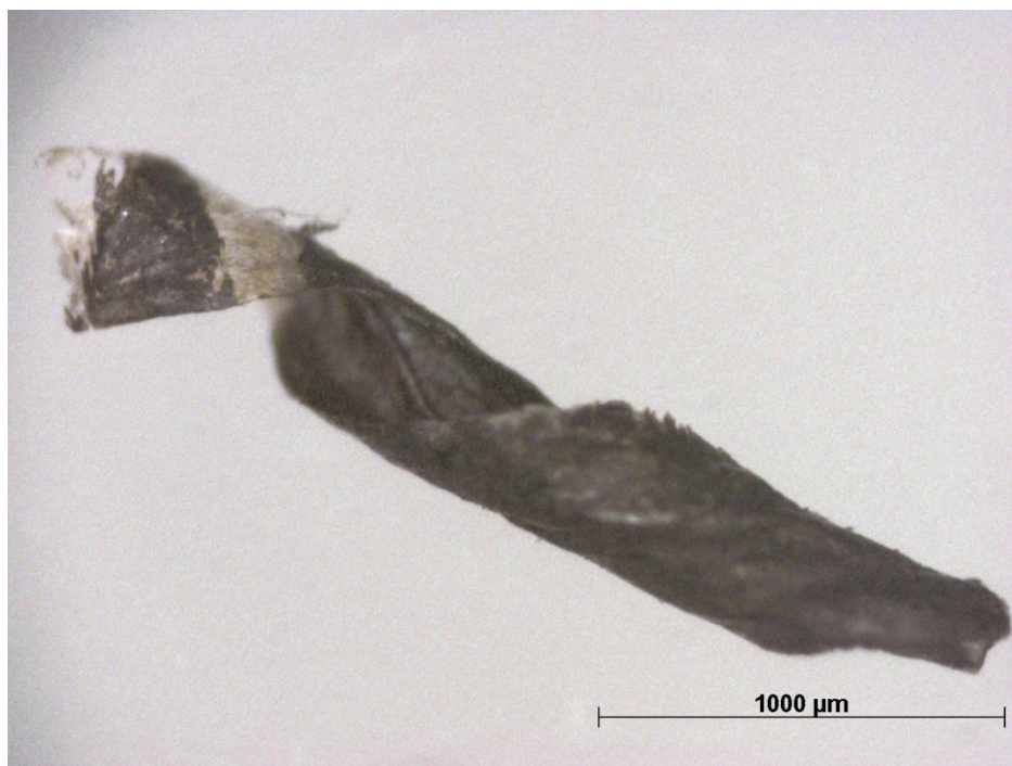
Figuur 18: metaalgedeelte bestaand uit darmvlies met een metaallaag (Zeiss Stemi, vergroting 50x)
