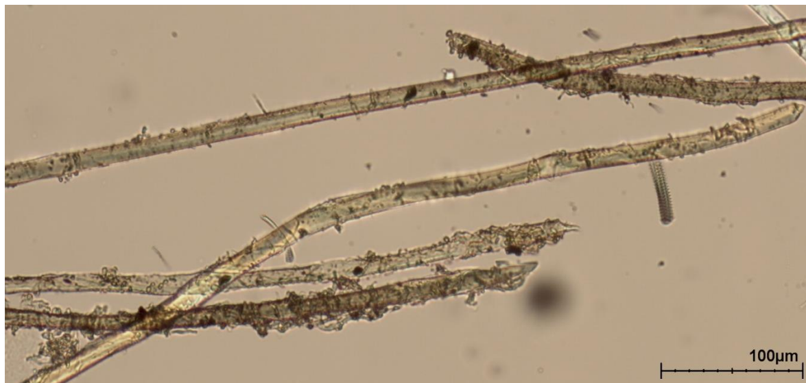
Figuur 13: Staal 12893/10 de vezels zijn lang en dun maar sterk gecontamineerd (Zeiss Stemi, vergroting 200x)
