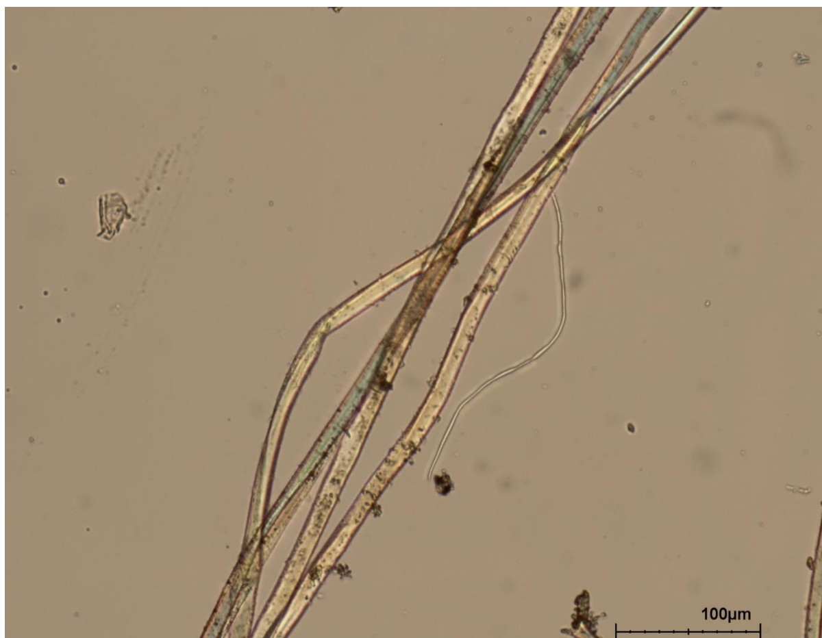
Figuur 10: Staal 12893/06 lange egale vezels, zoals staal 12893/05 (Zeiss Imager, vergroting 200x)
