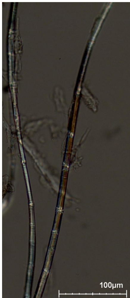
Figuur 20: Kerndraad van staal 12893/08 de vezels vertonen onder gepolariseerd licht laterale knopen wat er op wijst dat dit bastvezels zijn (Zeiss Stemi, vergroting 200x)
