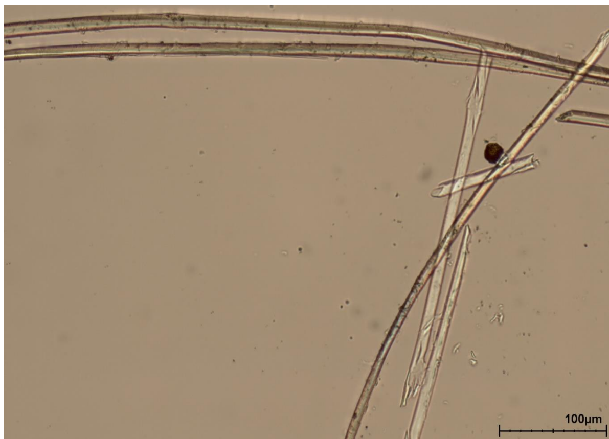
Figuur 11: Staal 12893/07 de vezels zijn egaal en dun (Zeiss Imager, vergroting 200x)
