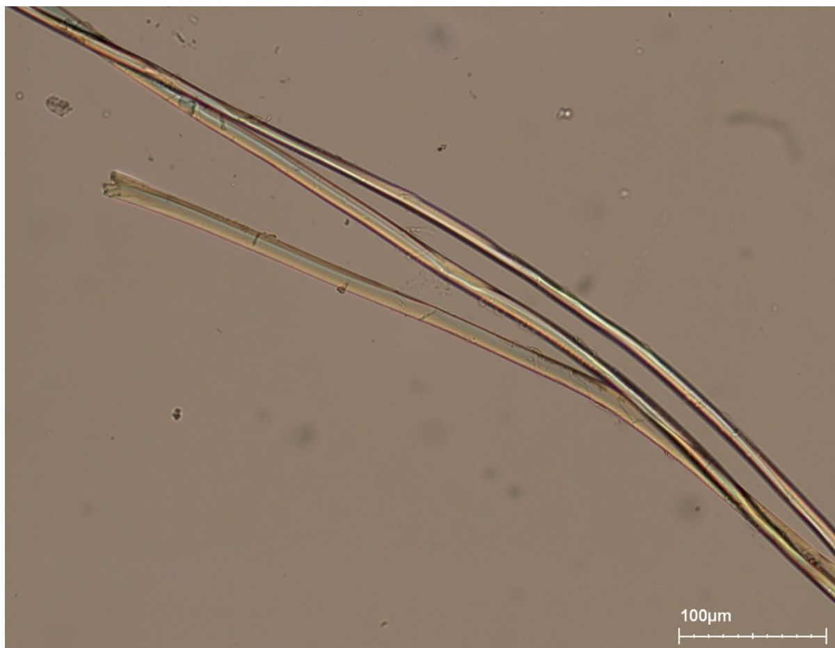
Figuur 8: Staal 12893/04 het staal bestaat uit lange, egale vezels (Zeiss Imager, vergroting 200x)
