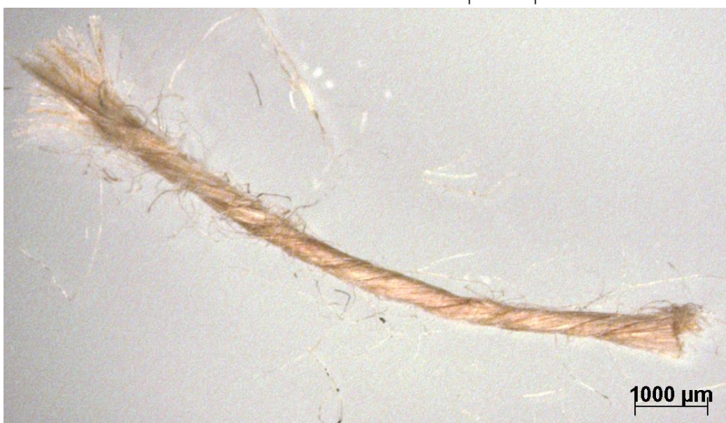
Figuur 17: Staal 12893/08 de metaaldraad is in een S-tors om de kern gewikkeld (boven), de textielkern bestaat zelf uit in S-tors gesponnen vezels (onder) (Zeiss Stemi, vergroting 10x)
